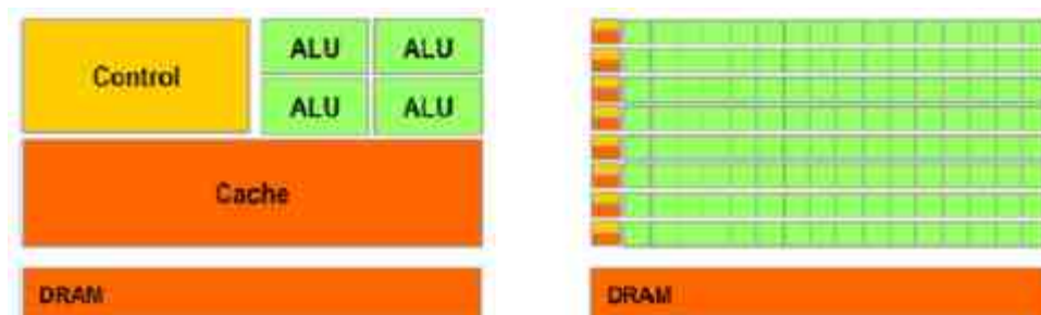
[그림] CPU(좌)와 GPU(우)의 회로도 비교
